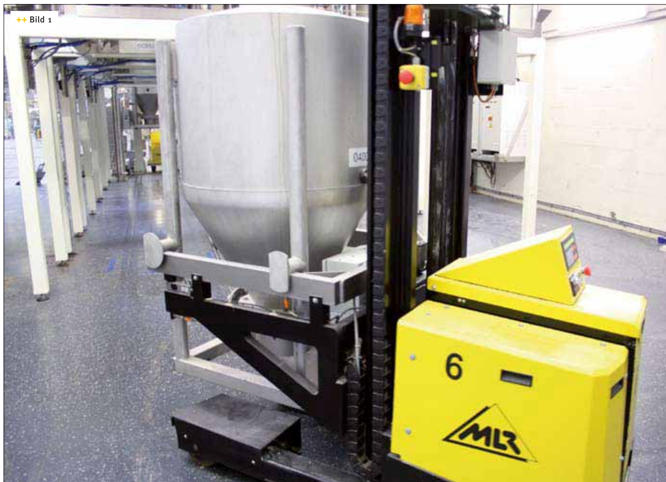
++ Bild 1 Wiegerahmen am Flurförderfahrzeug
