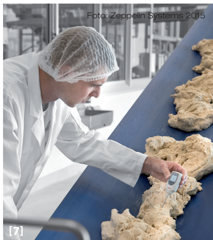
[7] Die kurzen Misch- und Knetzeiten im Codos System beanspruchen den Teig nur gering. Das sorgt für sehr konstante Temperaturen während des Prozesses. [8] Fundierte Informationen geben dem Bedienpersonal die Möglichkeit bei einer Auffälligkeit der Messwerte frühzeitig an der richtigen Stelle im Prozess einzugreifen.
