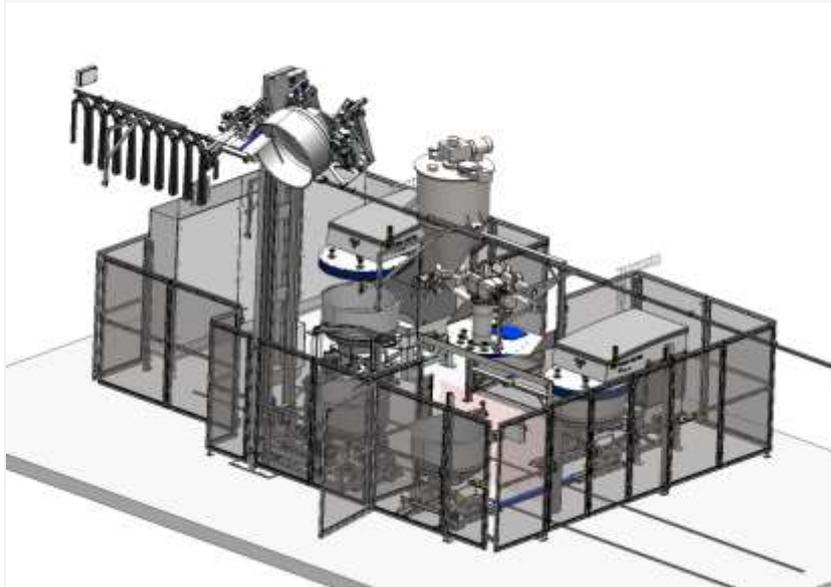
Knetvorgang mit Mehlbenetzung: Integration des DymoMix in ein Kronos-Linear-Knetsystem. Die Systeme bestehen aus einem Mischer für Trockenstoff mit DymoMix sowie zwei Kronos-Knetstationen mit Ruheplätzen und Hebelkipper zur Linienbeschickung. Die flüssigen Komponenten (z.B. Wasser und Hefesuspension) werden im DymoMix mit den Trockenstoffen zu einem Teig vermischt in den KRONOS-Knetern fertig geknetet.
