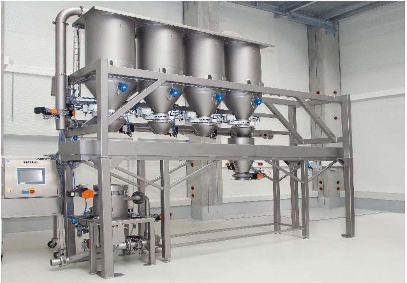
*Das Hochleistungsdosiersystem Micdos ist erweiterbar und erlaubt eine hohe Flexibilität bei der Anzahl der Zutaten*
