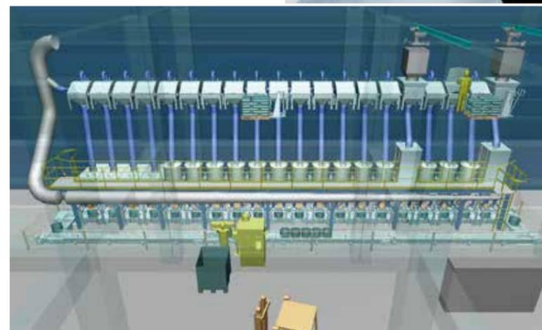
Handverwiegung war gestern: Kleinchemikalien werden bei Zeppelin automatisch abgewogen – die Einzelkomponenten direkt in den Beutel dosiert. Es werden keine weiteren Zwischengefäße benötigt. Das bedeutet: Höchste Präzision bei der Rezeptur, keine Verunreinigungen und kein human error. Dass die Beutel für die spätere Verarbeitung direkt bedruckt werden können, versteht sich von selbst.
