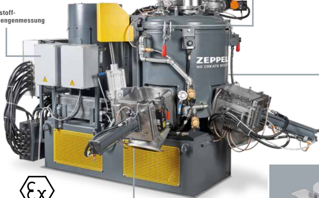
Pneumatischer Klappdeckel mit Leitflügel Klappbare Ausführung für leichtere Reinigung
