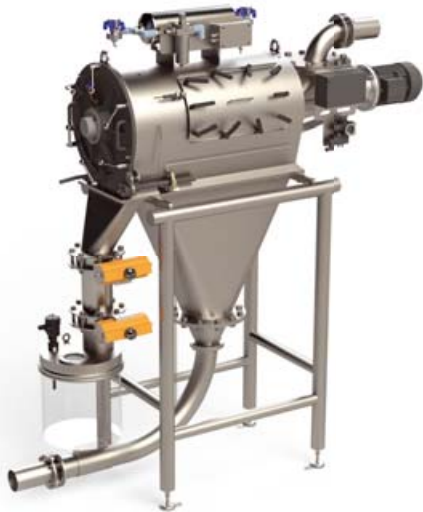
Anwendungsbeispiel: Siebmaschinenstation Application example: Rotary sifter station
